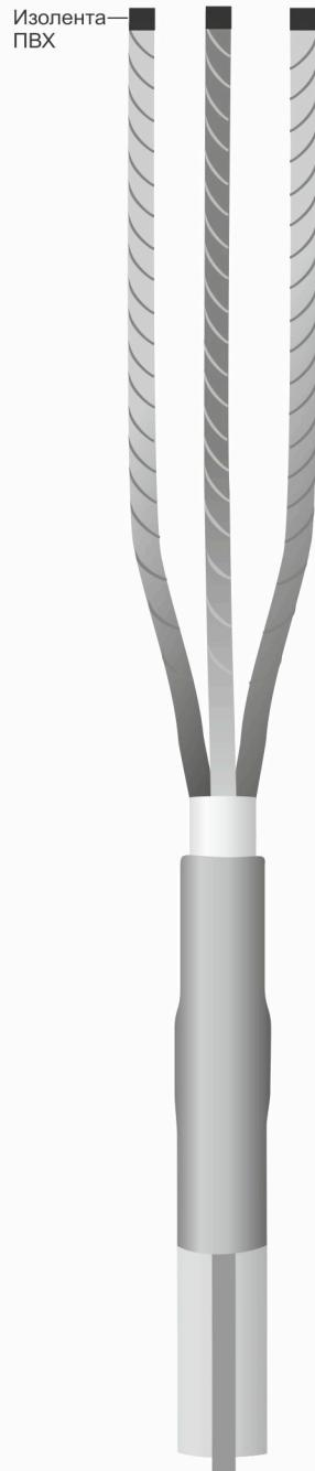
**Рис.5** Надеть на жилы изоляционные термоусаживаемые трубы, вплотную к металлической оболочке. Усадить трубы пламенем горелки, начиная от корешка разделки. После усадки под трубками не должно быть воздушных пузырей. Дать трубкам остыть. Очистить трубы от возможного нагара. Выполнить кольцевой надрез вокруг металлической оболочки на расстоянии **20мм** от среза металлической оболочки см. рис. 5.
